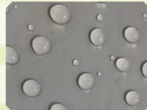
バッファークートは撥水塗膜を形成し、外部からの水分の侵入を防ぎます。
