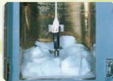
耐寒性試験の様子。 -50℃から200℃の範囲で塗膜変化がなく、低温での施工が可能です。
