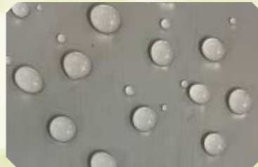
バッファークートは撥水塗膜を形成し、外部からの水分の侵入を防ぎます。
